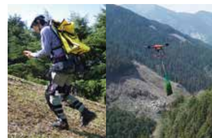
左/筋力負担を軽減できる林業用アシストスーツ 右/苗木運搬を効率化するドローンの開発
